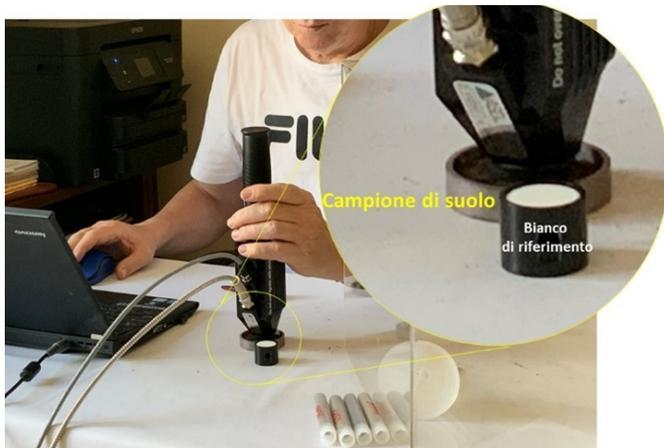
Foto 1 e 2: Misure spettroradiometriche su campioni di suolo in condizioni controllate d'illuminazione
