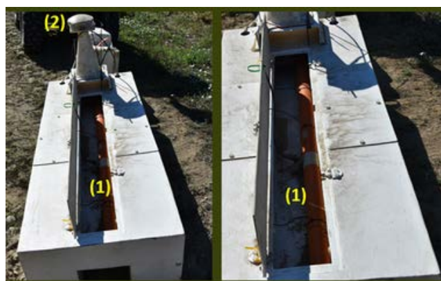
Fig. 2 – Elementi del sistema EMAS (Electro-Magnetic Agro Scanner) utilizzato per la scansione geofisica dei vigneti del Progetto PreCiVit.
